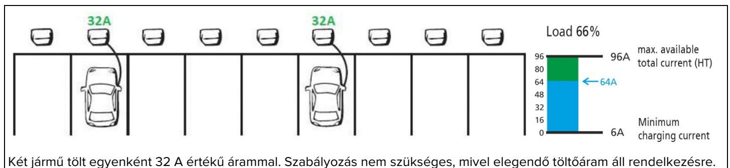
10. ábra: Terhelésmenedzsment üzemi állapot 1 példa
