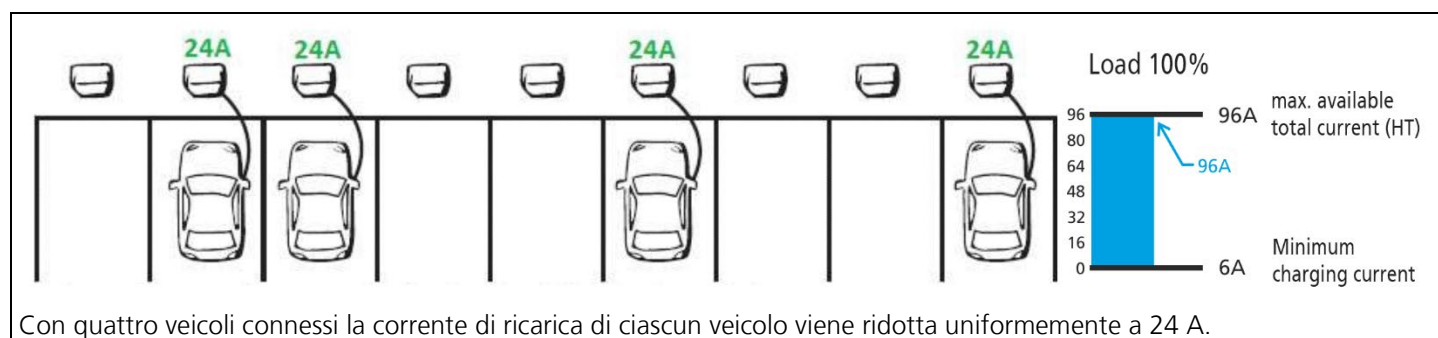
Fig. 11: esempio di gestione del carico - stato operativo 2
