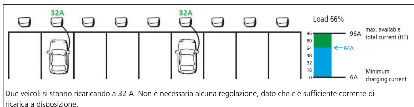
Fig. 10: esempio di gestione del carico - stato operativo 1
