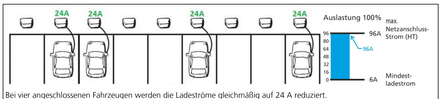
Abb. 11: Beispiel Lastmanagement Betriebszustand 2
