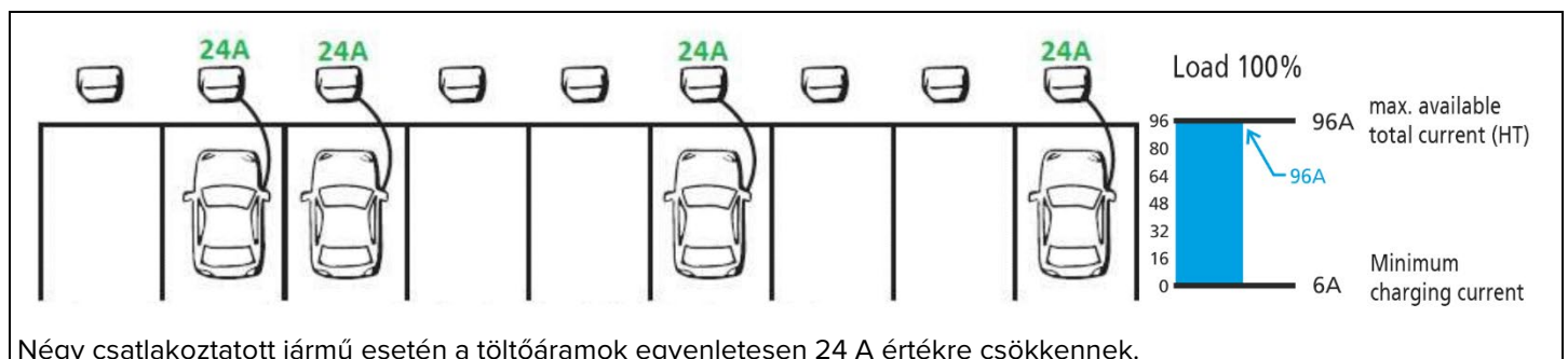
11. ábra: Terhelésmenedzsment üzemi állapot 2 példa
