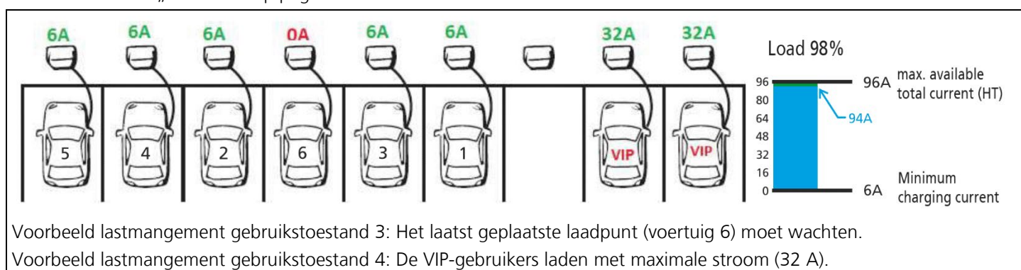
Afb. 12: Voorbeeld lastmanagement gebruikstoestand 3 en 4
