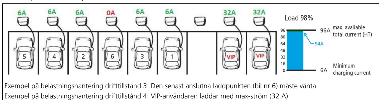
Bild 12: Exempel på belastningshantering drifttillstånd 3 och 4
