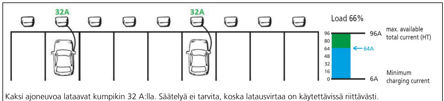
Kuva. 10: Esimerkki kuormituksenhallinnasta käyttötila 1
