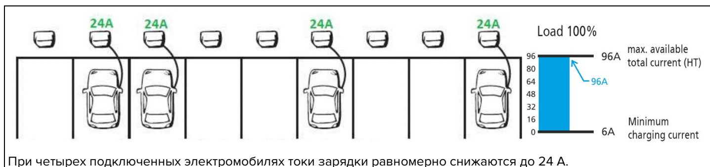
Рис. 11: Пример Управление нагрузкой Рабочее состояние 2
