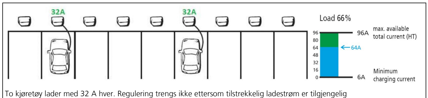
Fig. 10: Eksempel strømstyring driftstilstand 1
