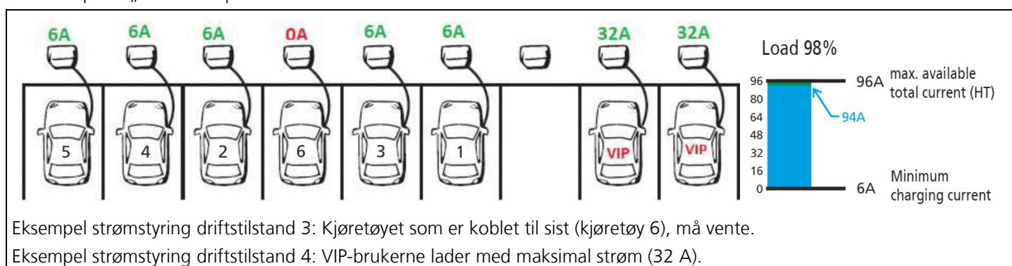
Fig. 12: Eksempel strømstyring driftstilstand 3 og 4
