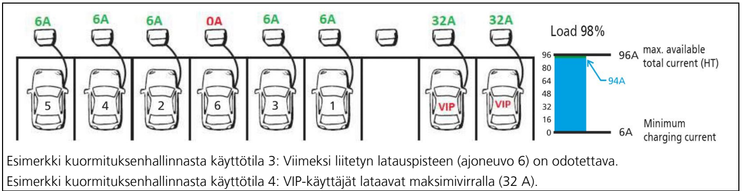
Kuva 12: Esimerkki kuormituksenhallinnasta käyttötila 3 ja 4
