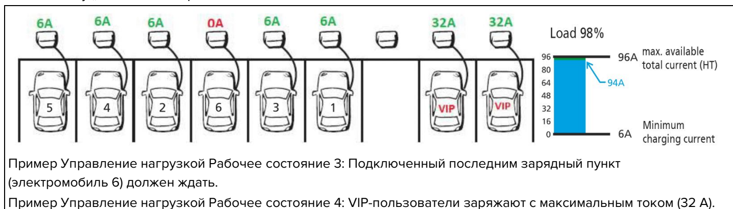
Рис. 12: Пример Управление нагрузкой Рабочее состояние 3 и 4
