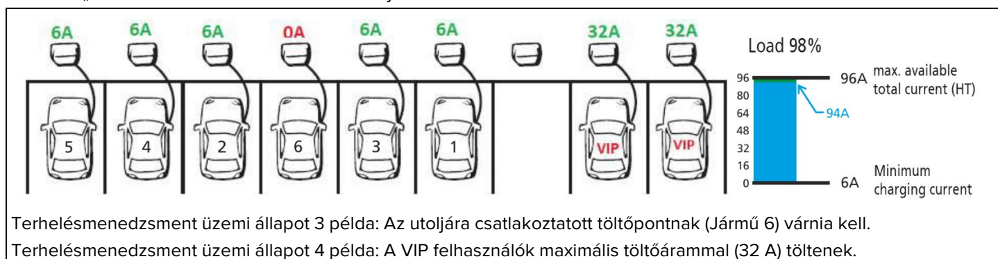
12 ábra: Terhelésmenedzsment üzemi állapot 3 és 4 példa
