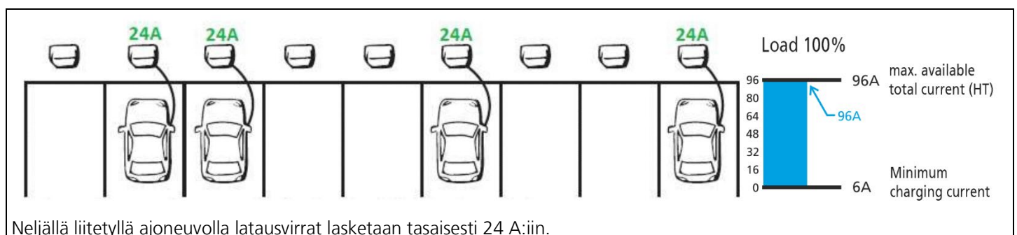
Kuva. 11: Esimerkki kuormituksenhallinnasta käyttötila 2
