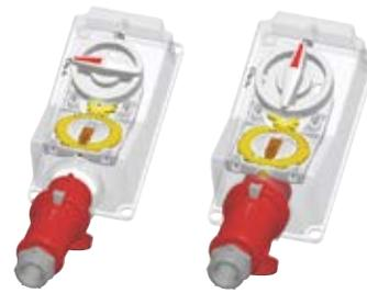
Nach dem Stecken und Einschalten ist der Stecker verriegelt. Nach dem Ausschalten und Ziehen des Steckers ist der Schalter verriegelt.
