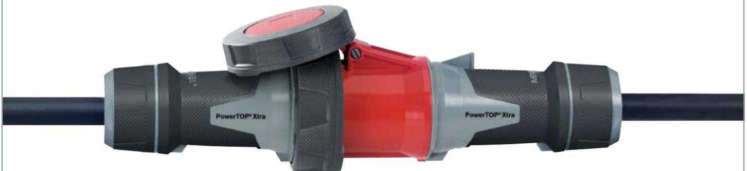
Mit gummierten Griffflächen für leichteres Stecken und Ziehen, mit Rahmenklemmen, hochwärmebeständigen Kontaktträgern, vernickelten Kontakten, Verschraubung mit Abdichtung, Zugentlastung und Kabelknickschutz, Gehäuse mit Gewindeverschluss und Sicherungsschieber für Gehäuse und Verschraubung. Höchste Sicherheit unter grosser Belastung.
